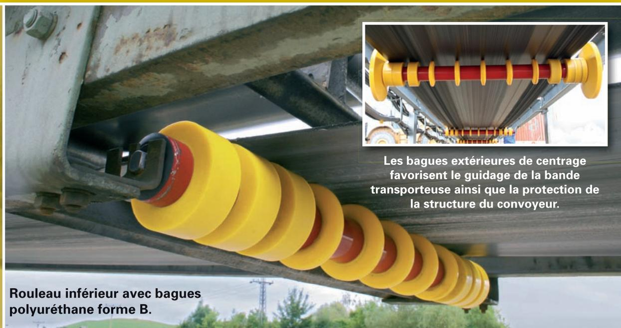
**Rouleau inférieur avec bagues polyuréthane forme B.**
