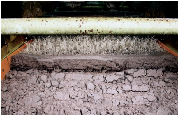
Crible essoreur équipé de barreaux d'obstruction
